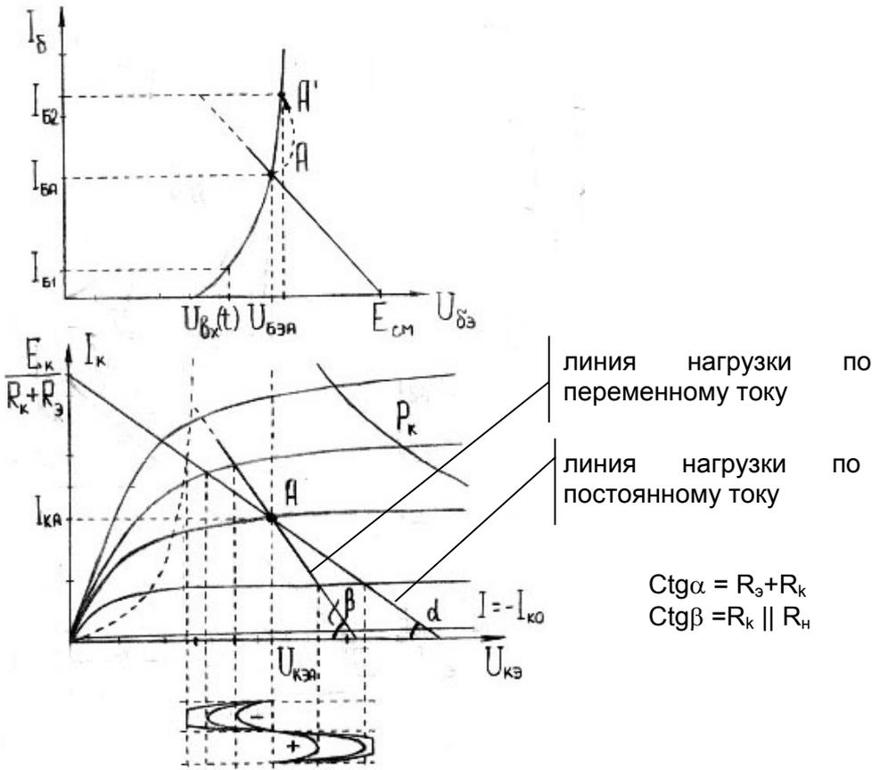
Подключение нагрузки приводит к ↓ усилению входного сигнала
