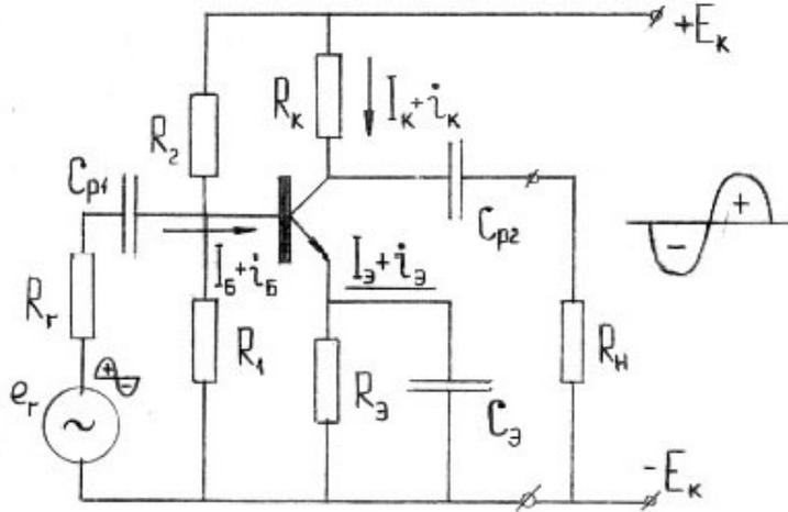
Назначение: Усиление переменного сигнала. Каскад с общим эмиттером переворачивает базу.
