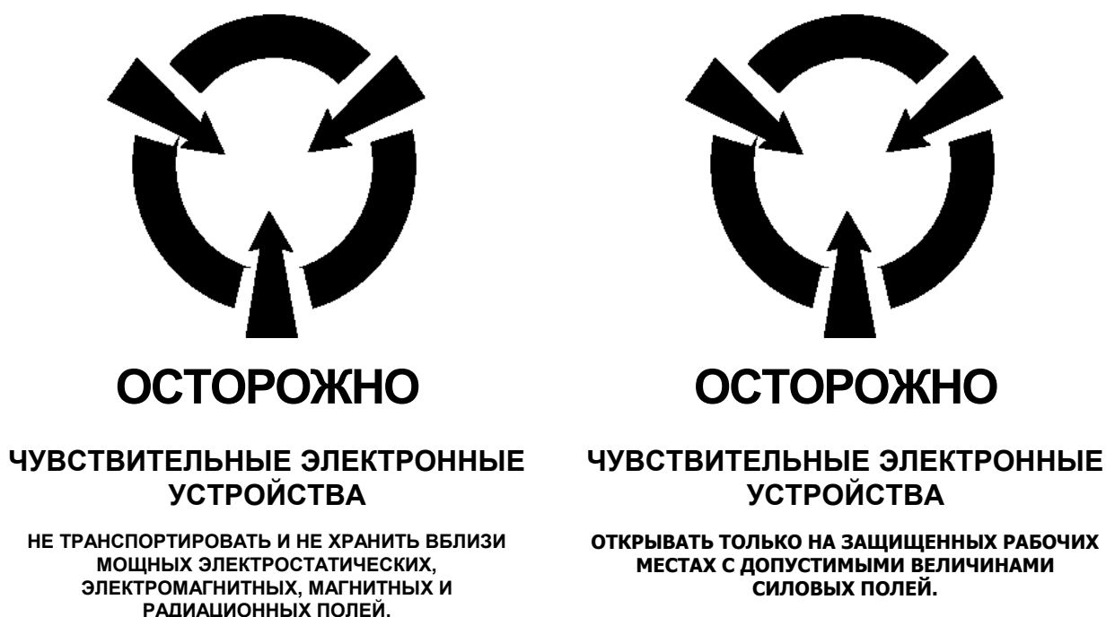
Рис.10.61. Обозначение устройств чувствительных к электростатическому разряду.
