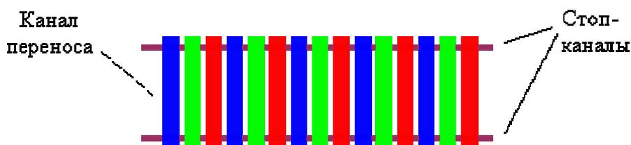
**Рис.1д. Вид на регистр «сверху». Канал переноса в боковом направлении ограничивается стоп-каналами.**
