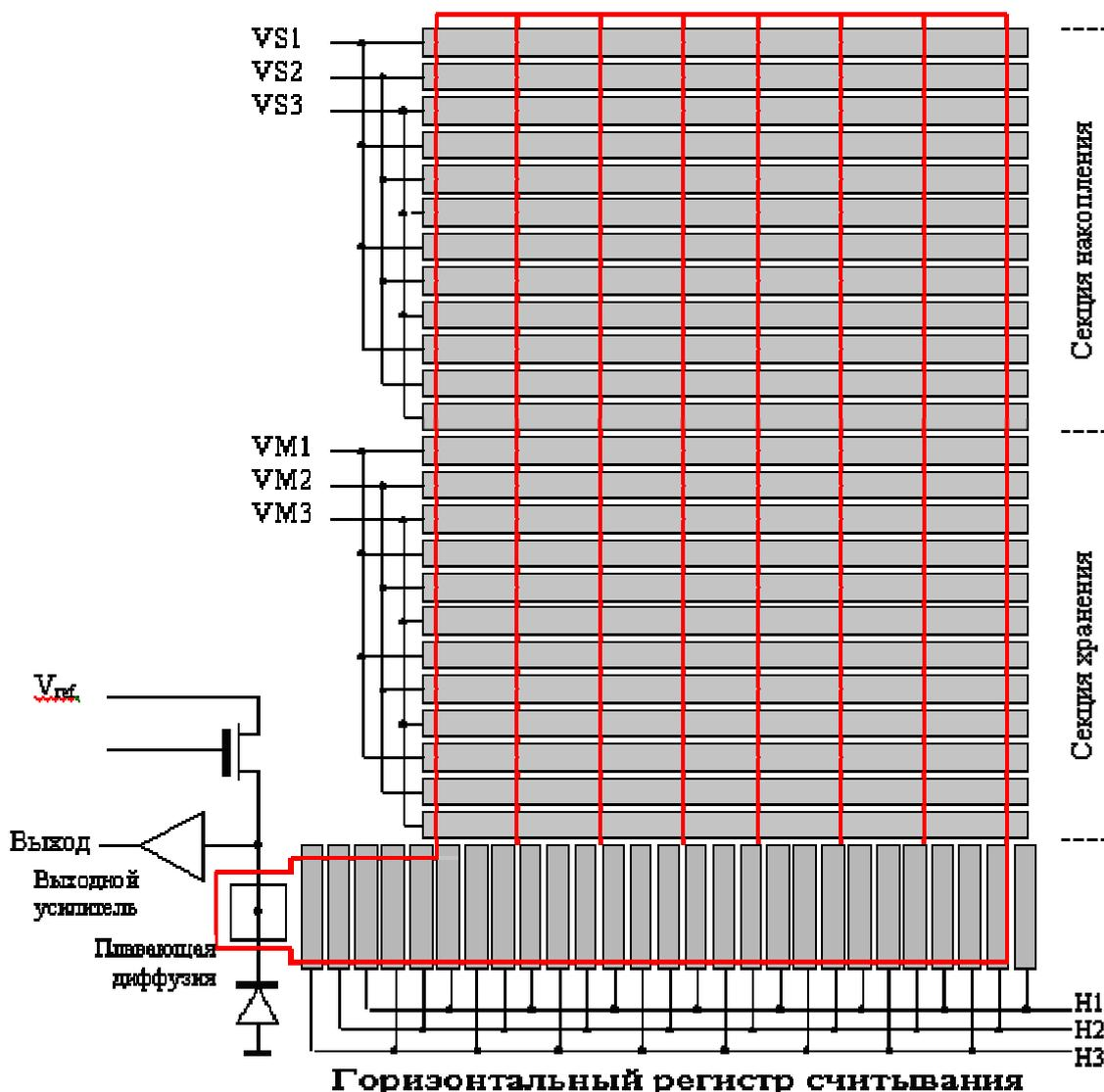
Рис.4а. Простейшая структура двумерной матрицы ПЗС.
