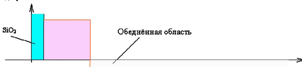
Рис.2а. Распределение зарядов в скрытом канале.
